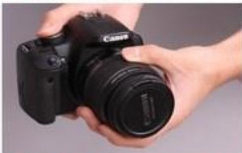
镜头插入机身，沿顺时针方向旋转镜头进行锁定。旋转镜头直至听到固定销到位的声音。
