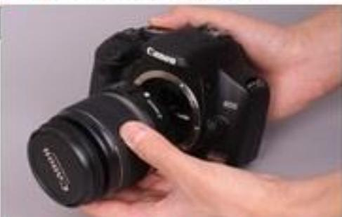
将镜头的白色标志与机身的白色标志对齐，缓慢平稳地将镜头安装于机身。安装时应注意避免镜头倾斜。
