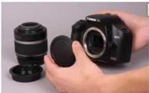
取下机身盖和镜头的后盖，准备安装镜头。安装过程中应注意避免灰尘进入相机内部。
